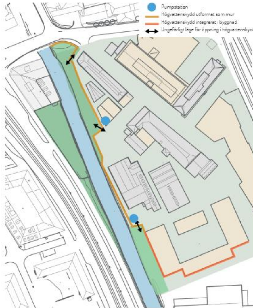
Figur 10. Illustration över planerat högvattenskydd. Illustrationen visar även hur högvattenskyddet kan komma att integreras i planerad byggnad. (Mareld landskapsarkitekter, 2023)
